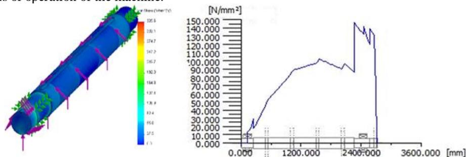
Fig. 2 Equivalent Stresses.
