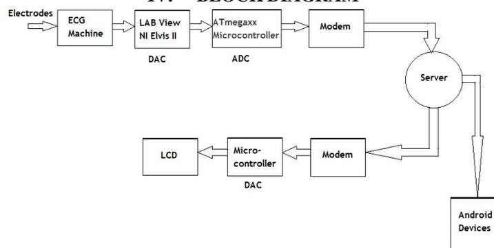
FIGURE 2. BLOCK DIAGRAM
